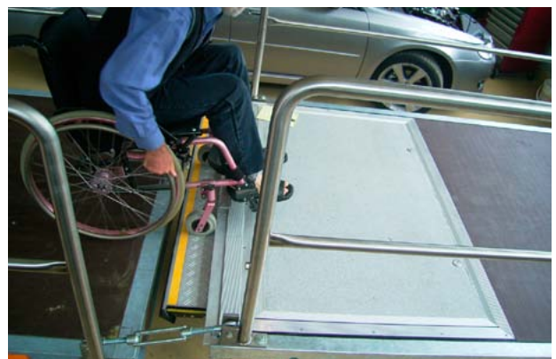
Das eigens für die Studie gebaute Testmodul mit Perron- und Fahrzeugteil
